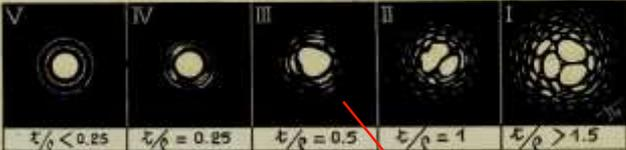
Fig. 149. — Échelle de cotation de la turbulence dans un petit instrument.
